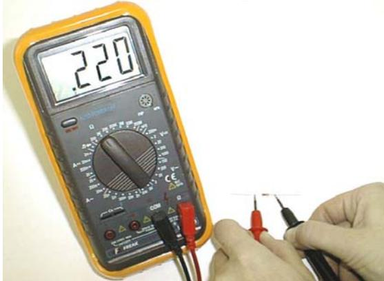
Figura 1-13. Clasificando las resistencias
