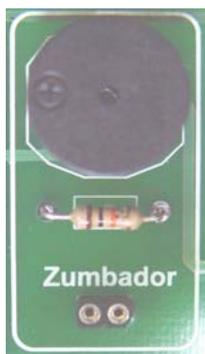
Figura 2-15. El zumbador piezoeléctrico
