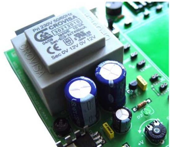
**Figura 1-29.** El transformador y condensadores de filtro
